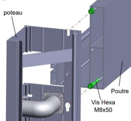
**2• Terminez la fixation de la poutre en ajoutant les 2 vis Hexa M8x50 et en serrant à la clé allen**
