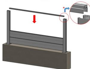
**Étape 2:** Faites glisser les deux closoirs tôle jusqu'au profil jonc.
