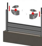
**Étape 3:** Faites glisser la tôle décor jusqu'au fond de la rainure du profil jonc.
