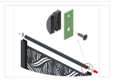
Étape 6 - Faites glisser le profil claustra jusqu'à être en appui sur les closoirs tôle
