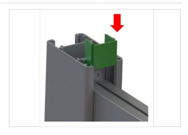
Étape 9 - Mettez en place le profil U finition (coupé à la longueur de l'entre poteaux à l'aide d'une scie à métaux) et le coller avec des points silicone au dessus du profil Claustra
