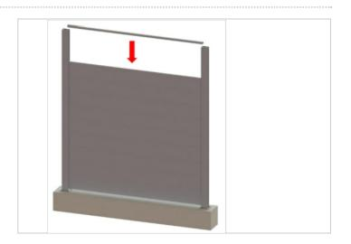
Étape 3 - Faites glisser les deux closoirs tôle jusqu'au profil jonc
