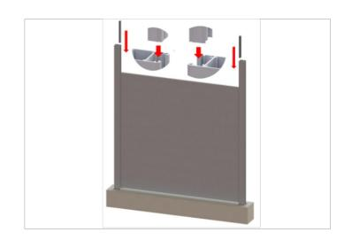
Étape 4 - Faites glisser la tôle décor jusqu'au fond de la rainure du profil jonc
