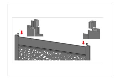
Étape 7 - Mettez en place le profil U finition (coupé à la longueur de l'entre poteau à l'aide d'une scie à métaux) et le coller avec des points de silicone au dessus de la dernière lame de la partie haute.
