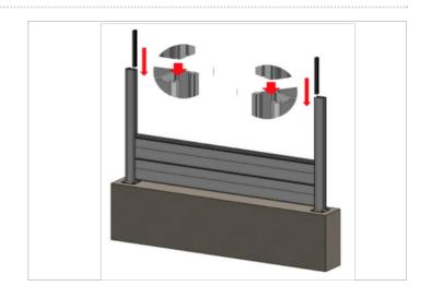
Étape 3 - Faites glisser la tôle décor jusqu'au fond de la rainure du profil jonc.
