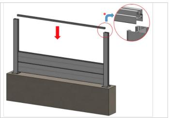
Étape 2 - Faites glisser les deux closoirs tôle jusqu'au profil jonc
