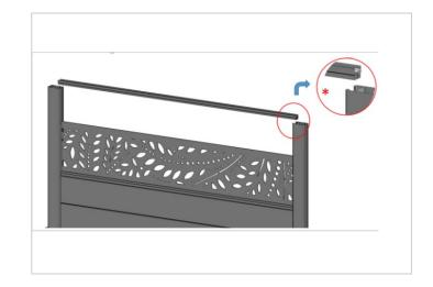
Étape 5 - Faites glisser la première lame de la partie haute (\* lame tête en bas ) jusqu'au profil jonc.
