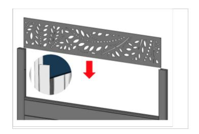
Étape 4 - Faites glisser le profil jonc (\* partie rainuré vers le bas) jusqu'à ce que la tôle décor soit en fond de rainure.
