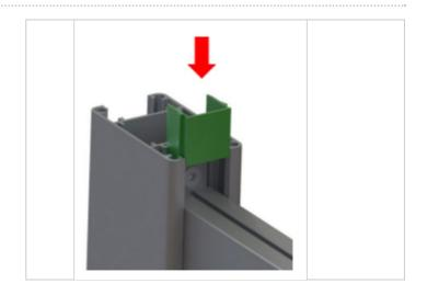
Étape 10 - Mettez en place le profil U finition (coupé à la longueur de l'entre poteaux à l'aide d'une scie à métaux) et le coller avec des points silicone au dessus du profil Claustra
