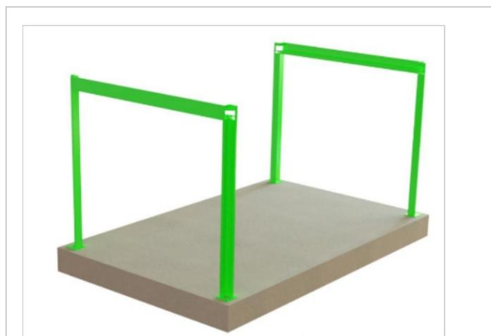
Étape 4 - Fixez les platines à la dalle béton avec des goujons d'encrage M10x150. Bien vérifier l'aplomb des montants
