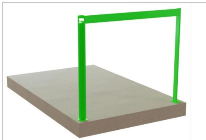
Étape 2 - Fixez les platines à la dalle béton avec des goujons d'encrage M10x150. Bien vérifier l'aplomb des montants
