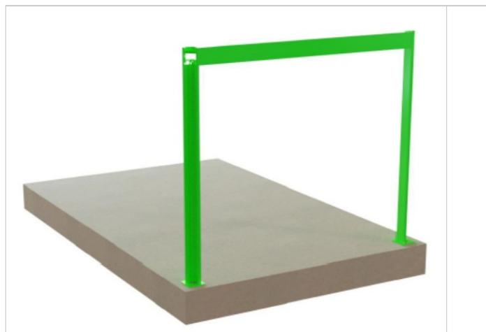
Étape 2 - Fixez les platines à la dalle béton avec des goujons d'encrage M10x150. Bien vérifier l'aplomb des poteaux
