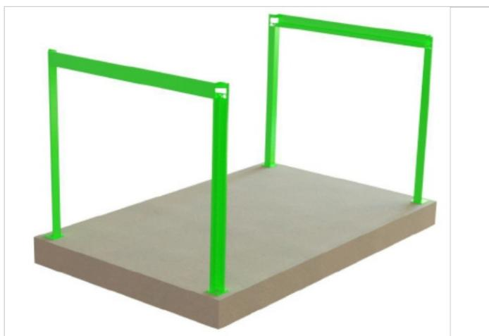
Étape 4 - Fixez les platines à la dalle béton avec des goujons d'encrage M10x150. Bien vérifier l'aplomb des poteaux
