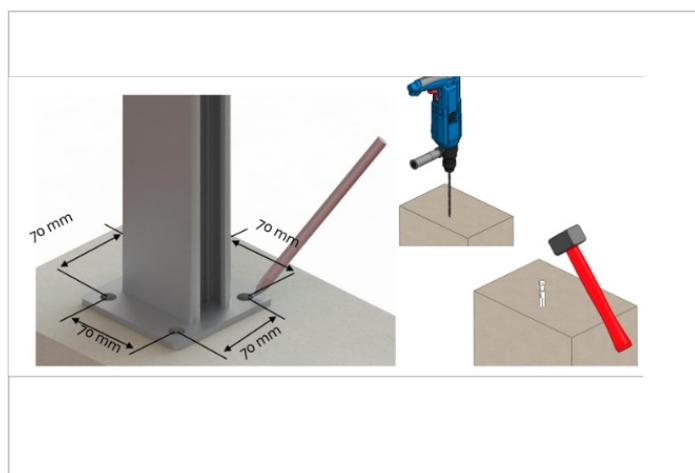
Étape 2 - Fixez les poteaux au support en vérifiant l'aplomb (calez sous la platine si nécessaire)
