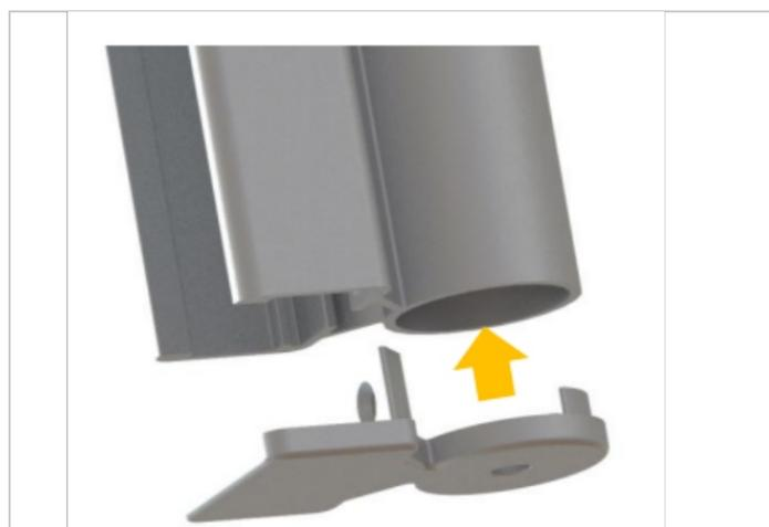
Étape 2 - Clippez les profils d'angle avec l'embout en bas dans chaque poteau, l'embout bas doit reposer sur la platine. (le poteau doit avoir été fixé au muret)
