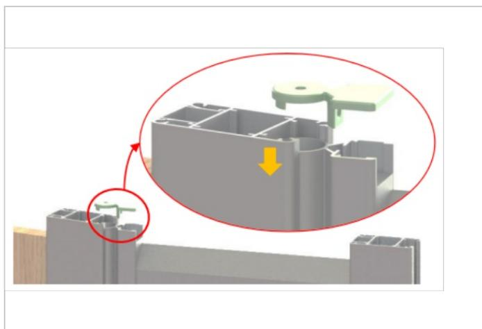
Étape 4 - Vissez l'embout haut au profil d'angle avec une vis autoforante 3,5x16 mm .
