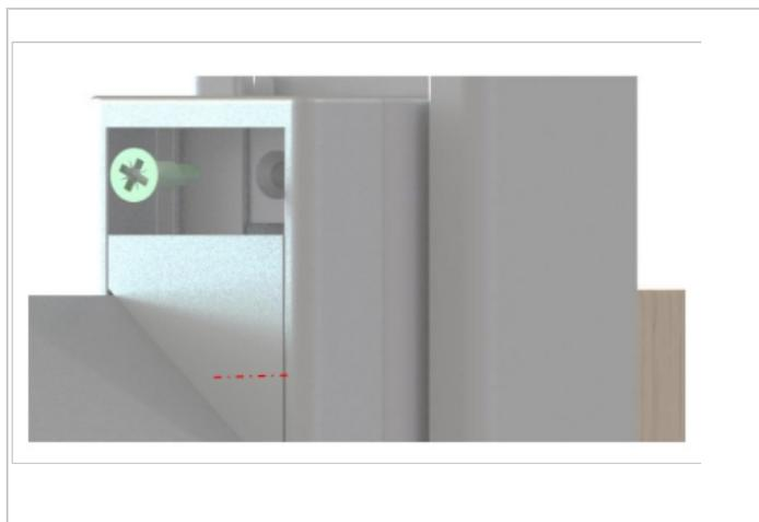
Étape 5 - Insérez le closoir haut du profil d'angle sous l'embout haut du profil angle
