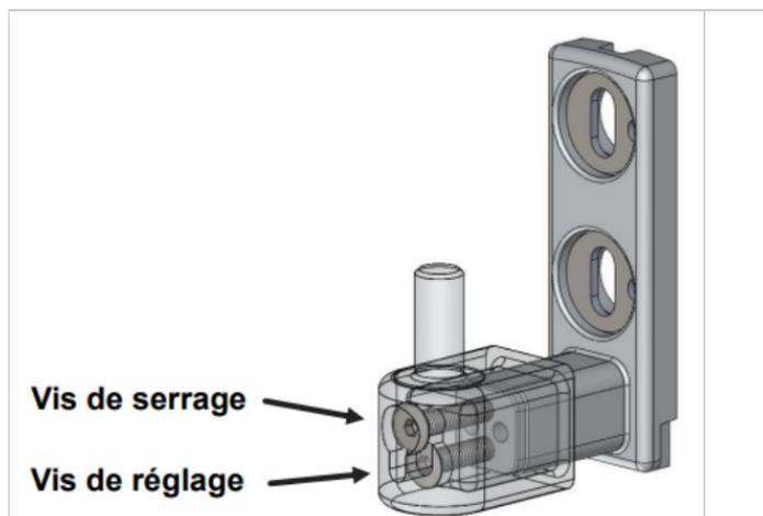
Étape 5 - Placez le second gond bas à l'axe du pilier et tracer les perçage (ajustez la hauteur par rapport au gond bas ayant le niveau le plus bas)
