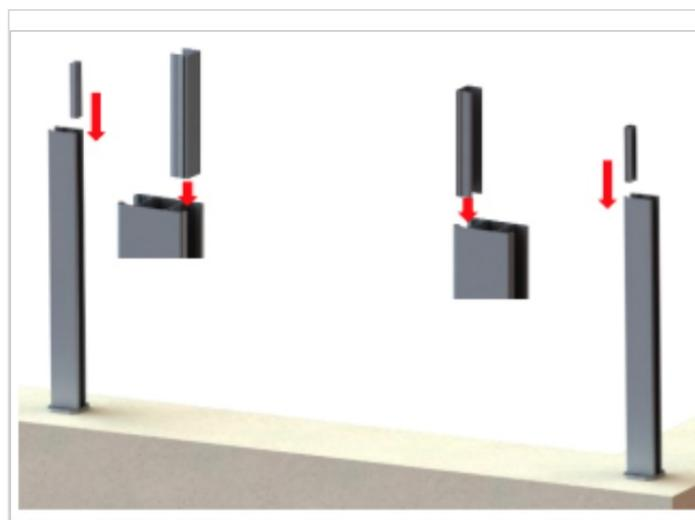
Étape 2 - Commencez à insérer l'élément de clôture dans les poteaux jusqu'au dessus de la traverse basse
