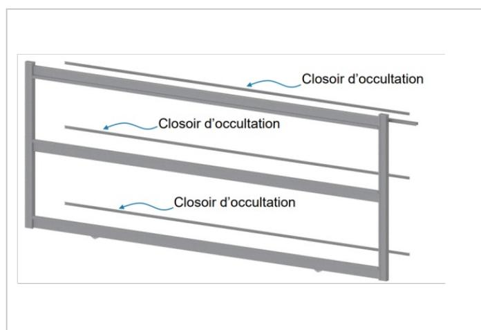
Étape 2 - La fixation de l'habillage se fait en vissant vos lames par l'arrière des profils.
