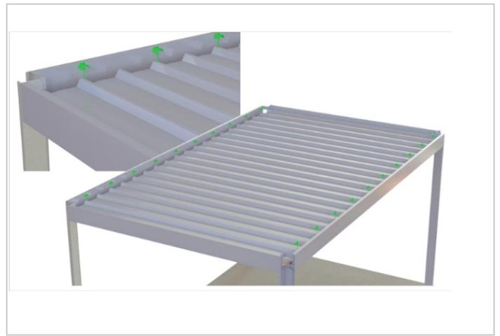
Étape 6 - Finalisez le toit en mettant un joint de silicone entre la poutre « largeur » et le premier panneau de toit
