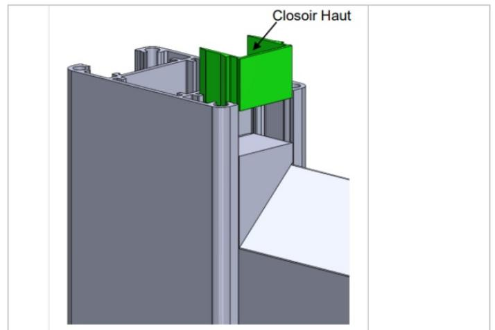
Étape 7 - Faites glisser les cloisirs de finitions jusqu'au muret ou platine
