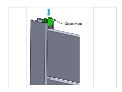
Étape 6 - Faites glisser les closoirs de finitions jusqu'au muret ou platine
