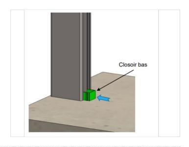
Étape 2 - Faites glisser la première lame dans les rainures des poteaux jusqu'aux closoirs bas.
