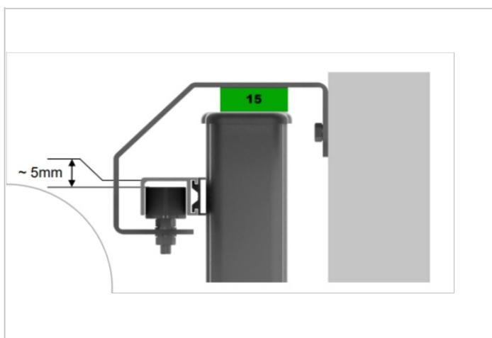
Étape 6 - A l'aide d'un niveau à bulle, contrôlez l'aplomb du portail. Au besoin, ajustez l'aplomb en jouant sur la position des roulettes de guidage
