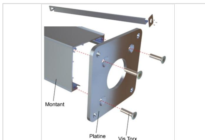
Étape 2 - Glissez les pièces d'équerrage sur les montants. Ajoutez un petit point de silicone pour les fixer totalement. Laissez 40 mm entre le haut du montant et la pièce d'équerrage
