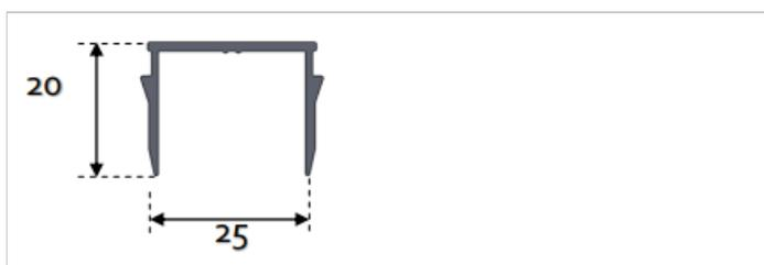
Le montage des closoirs doit s'effectuer une fois les poteaux fixés.
