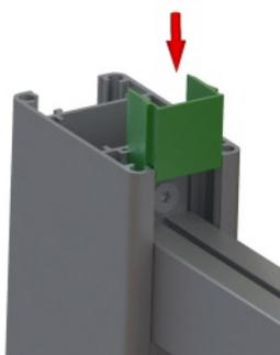
**Étape 19 :** Mettez en place le profil U finition (coupé à la longueur de l'entre poteaux à l'aide d'une scie à métaux) et le collez avec des points silicone au dessus du profil Claustra
